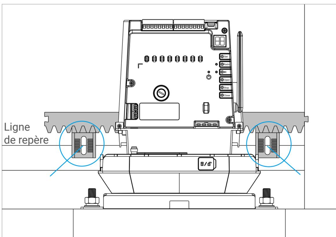
**i** Laissez une distance de 1 à 1,5 mm entre la crémaillère et la roue dentée du moteur d'entraînement. Si, malgré vos efforts, la distance reste trop importante, envisagez d'ajouter une plaque de calage (percée de trous pour le passage des vis) entre le moteur de portail et la base de montage.
