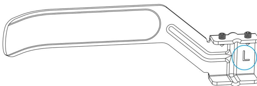
3. Fixez la tôle de butée gauche sur la crémaillère du côté gauche du moteur de portail (en veillant à ce que la partie pliée de la tôle de butée soit au-dessus de la crémaillère).
