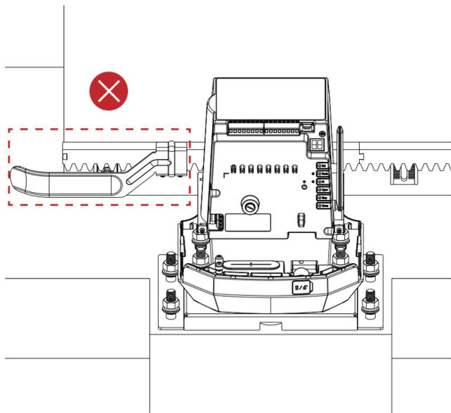
La partie pliée de la tôle de butée n'est pas en contact avec le ressort du moteur de portail.
