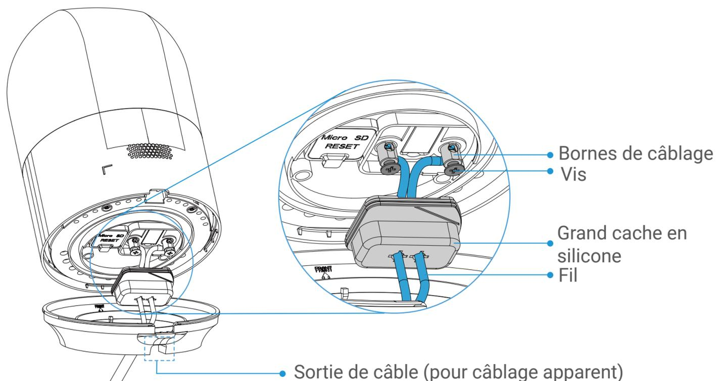
**i** Si vous utilisez un câblage apparent, guidez les fils à travers la sortie de câbles après le raccordement.
