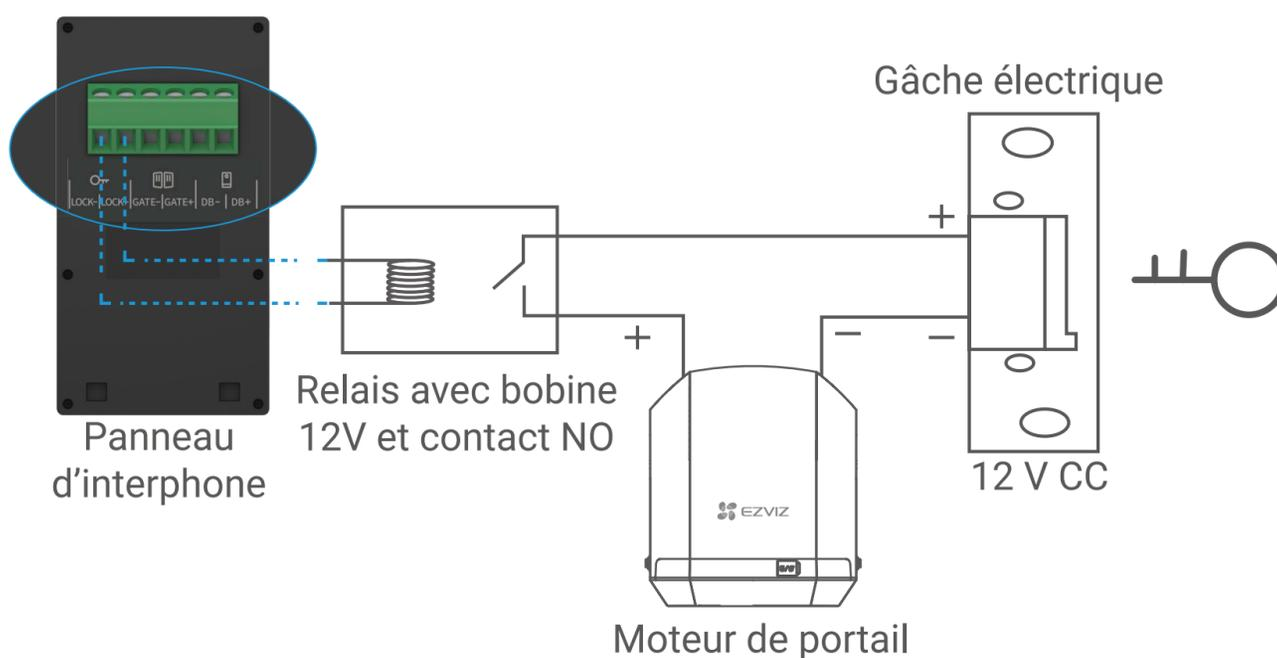
Connectez les fils de votre gâche électrique aux bornes 5 et 6 (« LOCK ») du moteur de portail. Veillez à connecter le fil positif à la borne 6 et le fil négatif à la borne 5.
