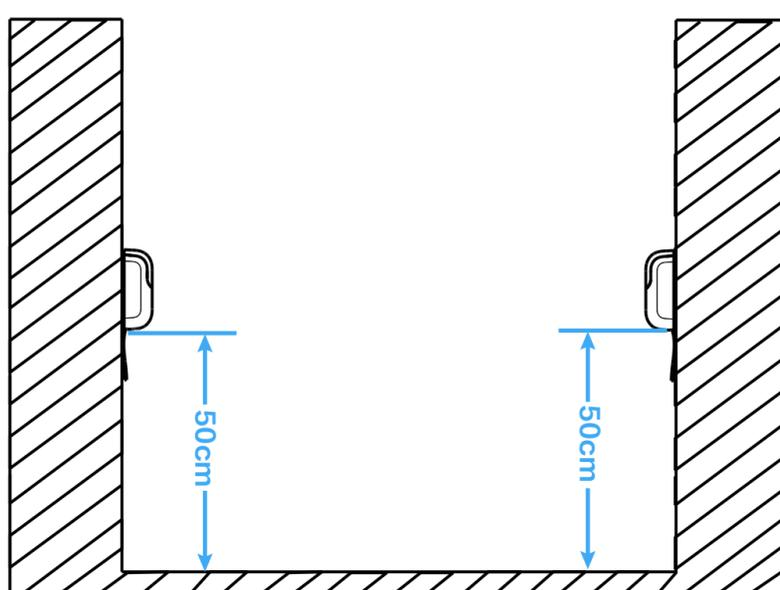
**i** Les photocellules peuvent être installées soit à l'intérieur du portail, soit à l'extérieur, sur le pilier.
