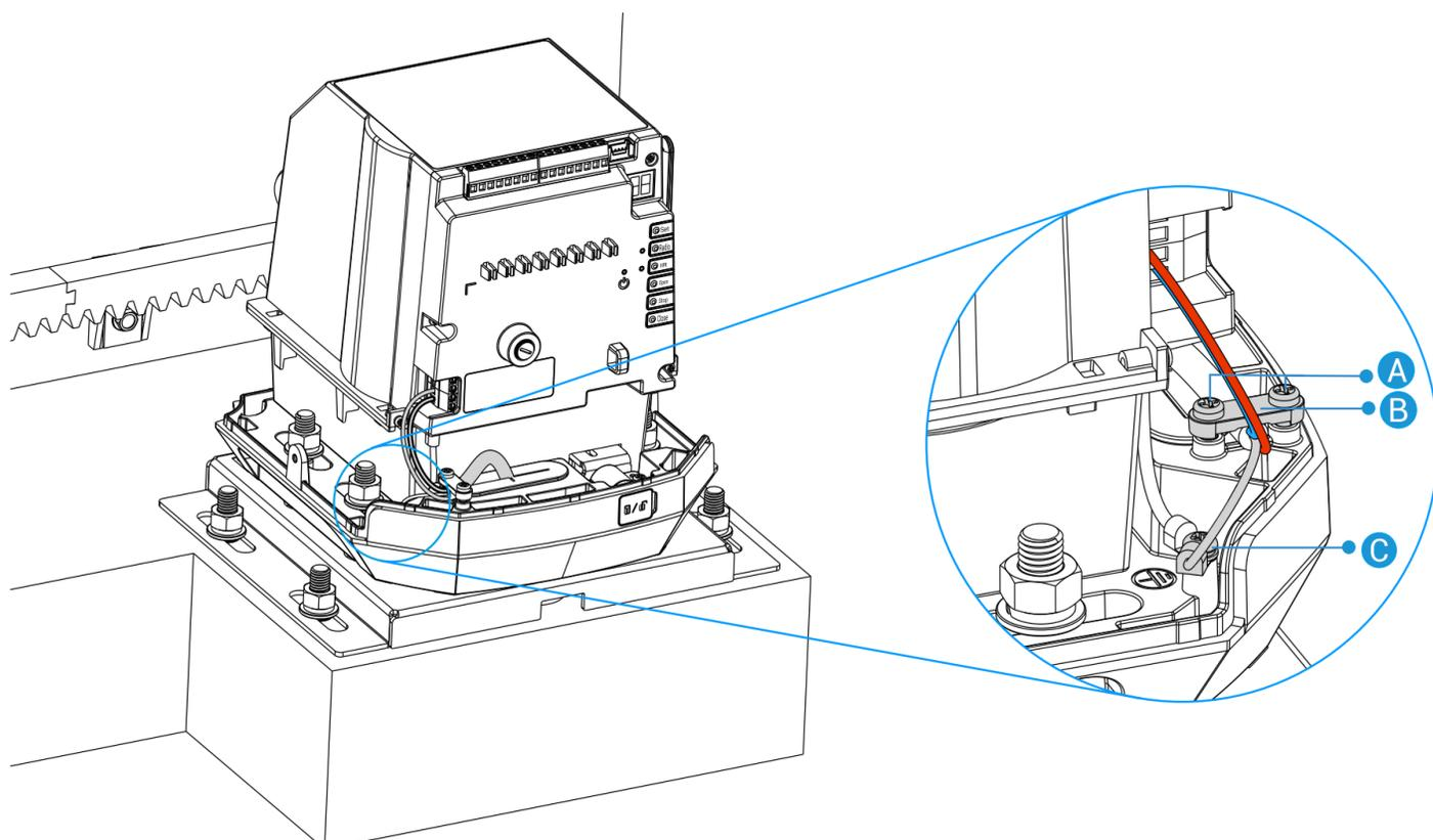
2. Connectez le fil de phase (fil rouge sur la figure) à l'interface L et le fil neutre (fil bleu sur la figure) à l'interface N (reportez-vous à l'étiquette sur le moteur de portail, comme illustré ci-dessous).
