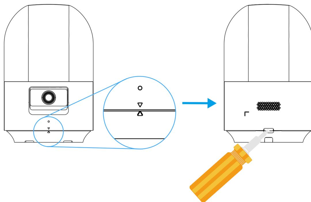
5. Ouvrez le petit cache en silicone situé au bas du boîtier de la caméra, insérez une carte Micro SD (vendue séparément) dans le logement prévu à cet effet, puis remettez le cache en place.
