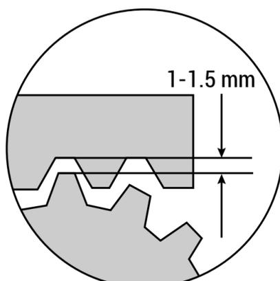
4. Utilisez des vis et des rondelles pour fixer la crémaillère au centre des trous oblongs (sur la ligne de repère), tout en utilisant le niveau à bulle fourni afin de vous assurer que la crémaillère est en position horizontale.
