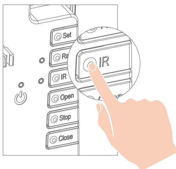
2. Le indicateur IR devient rouge fixe, indiquant que le moteur de portail est passé en mode d'auto-test infrarouge.
