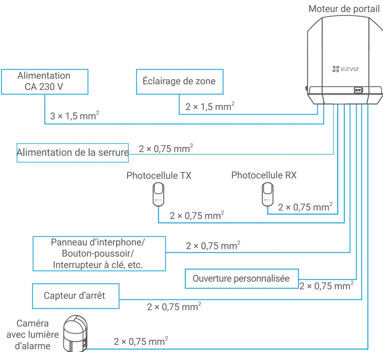
L'étiquette « Cable Connection Instructions (Instructions de connexion des câbles)» (située sur le dessus du moteur de portail) décrit les connexions des borniers, comme indiqué dans le tableau ci-dessous.
